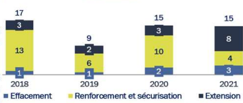
Répartition des linéaires de réseau HTA posé par le SDEC ÉNERGIE par type de travaux en km par année de programmation
