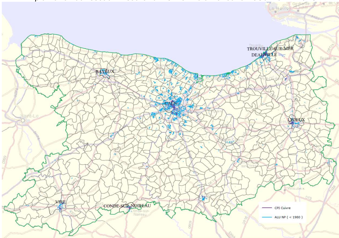
Implantation du réseau BT souterrain CPI et Alu antérieur à 1980 – à fin 2015
